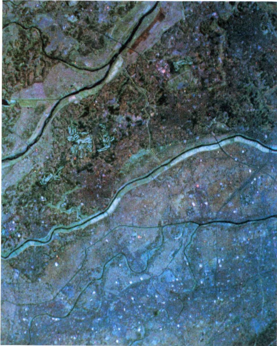
写真1 1/5万・地形図野田図幅範囲TM合成カラー画像 バンド3(B), 5(G), 7(R) (印刷縮率: 70%)
