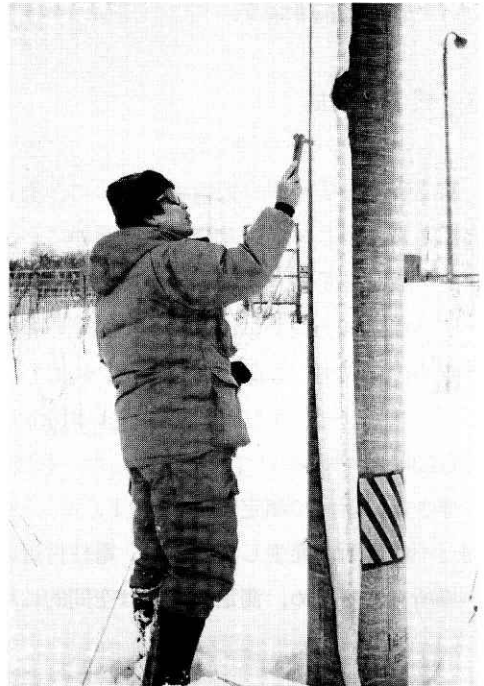
写真2 電柱着雪の観測状況
