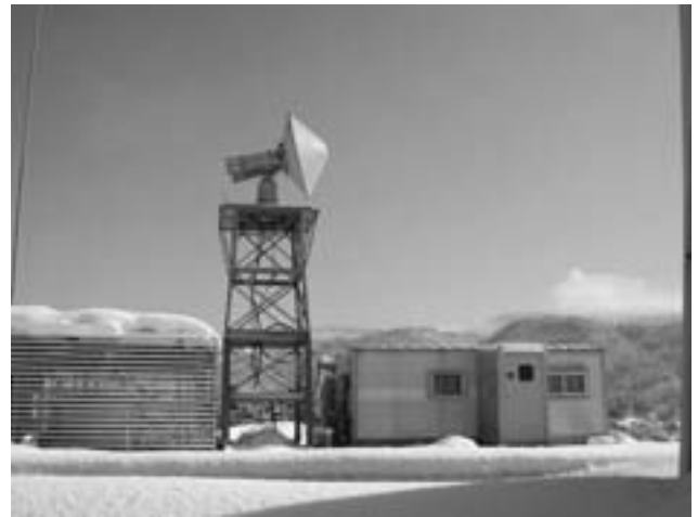
図 2 観測に使用した防災科学技術研究所 X バンドドップラーレーダー (X-POL)
