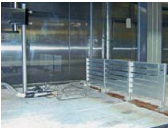
写真5 トラバース装置に取り付けた超音波風速計のセンサー
