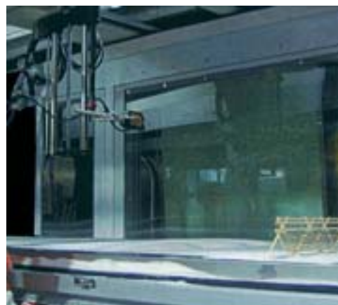
写真 4 トラバース装置に取り付けたレーザー距離計のセンサー Photo 4 Sensor of laser distance meter attached to the traverse device.
