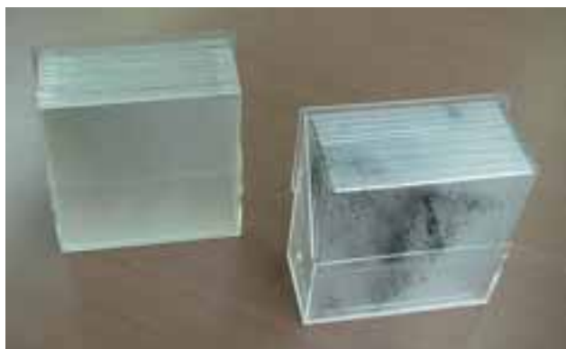
図4 アクリル板方式（左）およびアクリル枠方式（右） Fig. 4 Acryl plate type (left) and acryl frame type (right).
