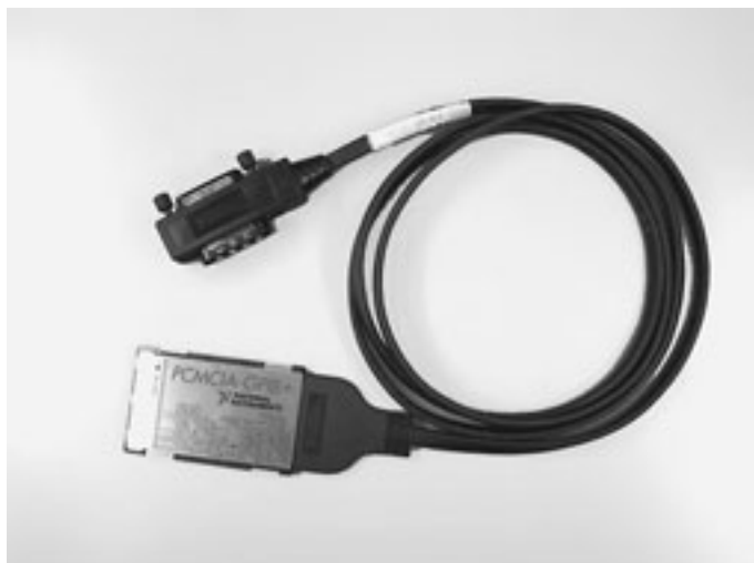
図2 GPIB カードとケーブル Fig. 2 GPIB card and cable (national instruments Co.).
