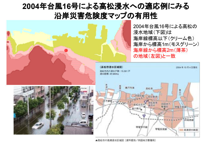
図6 高松市内周辺での沿岸災害危険度マップの表示画面(上図)と2004年台風16号による高潮による浸水被害域(右下図)および浸水被害時の写真(左下図)。
