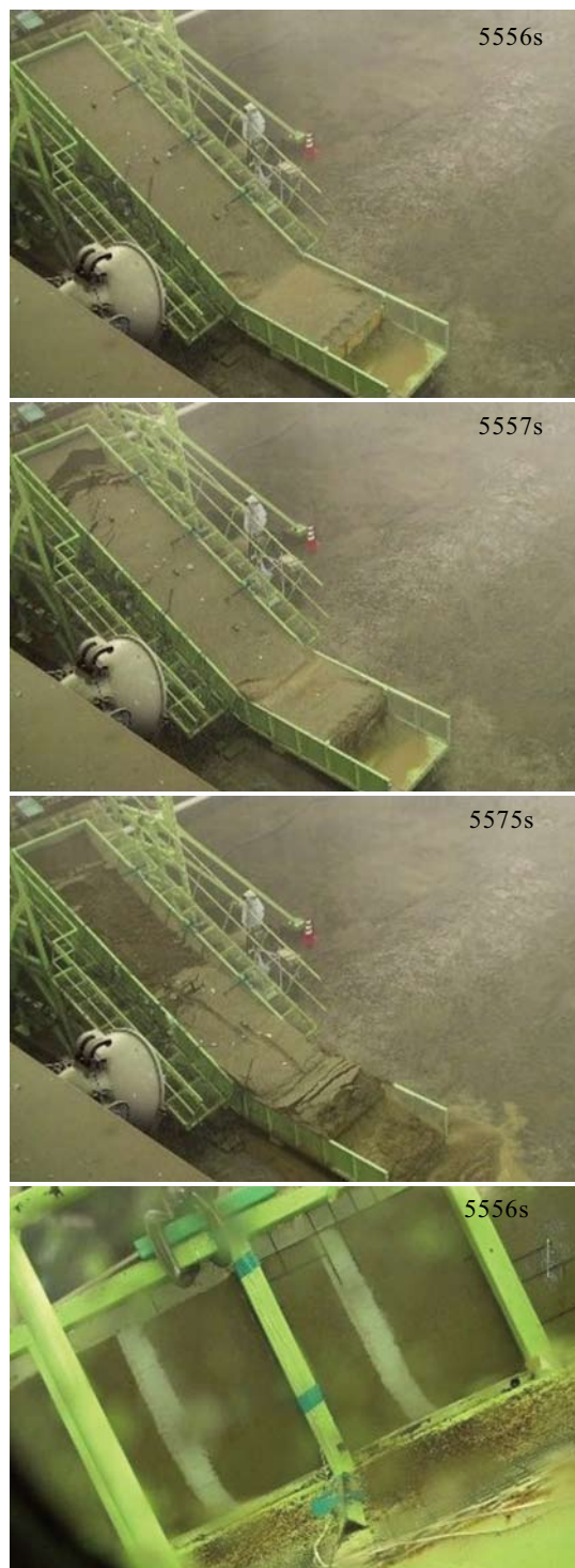
図 25 中型 30 度マサ斜面 崩壊時の状況 Fig. 25 Behavior of slope failure of medium-scale slope of 30 degrees.
