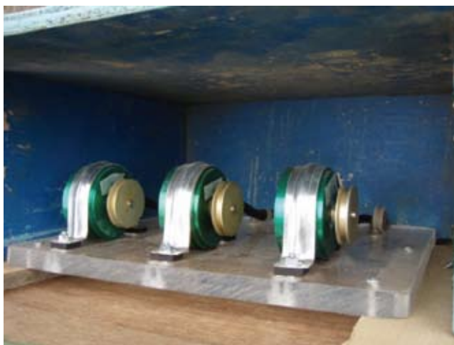
図1 地表面移動計の形状 Fig. 1 Shape of extensometer.
