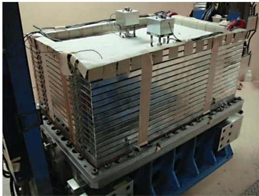
写真 1 遠心振動実験の試験体外観 Photo 1 Specimen of Centrifuge test.
