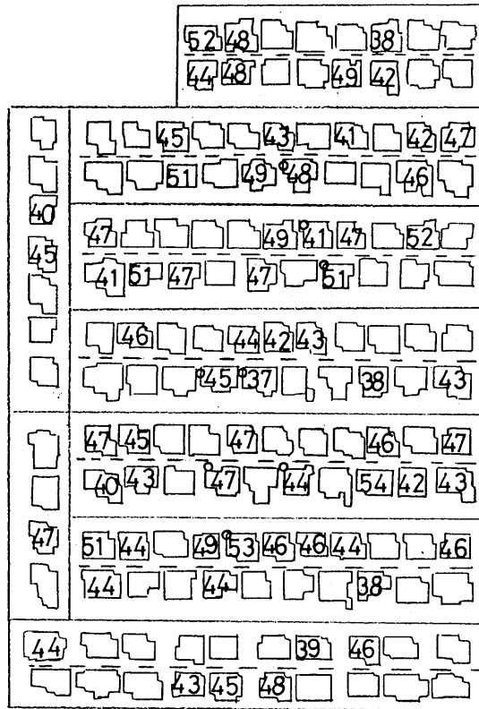
図 5.5 アンケート調査による震度分布図（美浜三丁目の住宅地）
