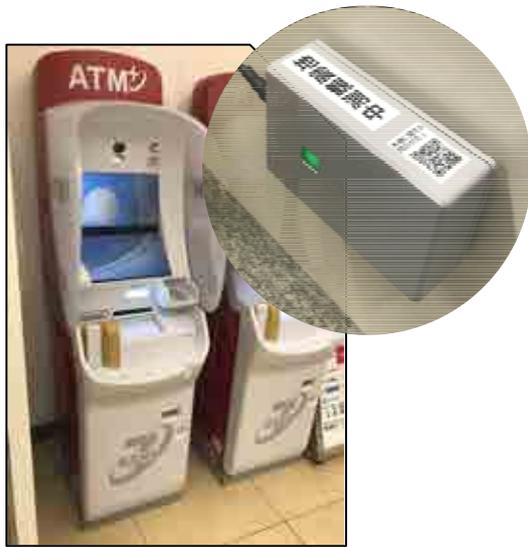
図 20 ATM への地震計設置状況
