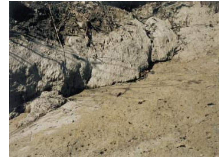
写真18 白河溶結凝灰岩の風化状況と崩壊発生位置 Photo 18 Weathered Shira-kawa welded tuff.
