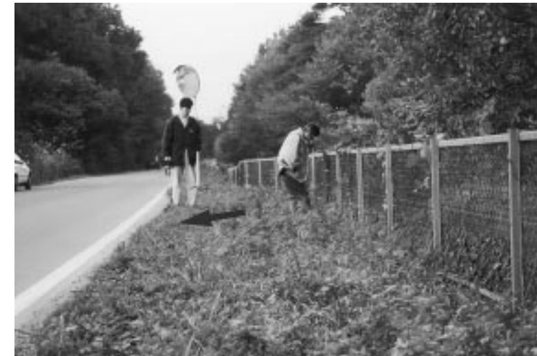
写真11.1 那須疎水の洪水痕跡(金網に架かったゴミ)
