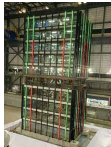
図3 10層鉄骨造建物実験
