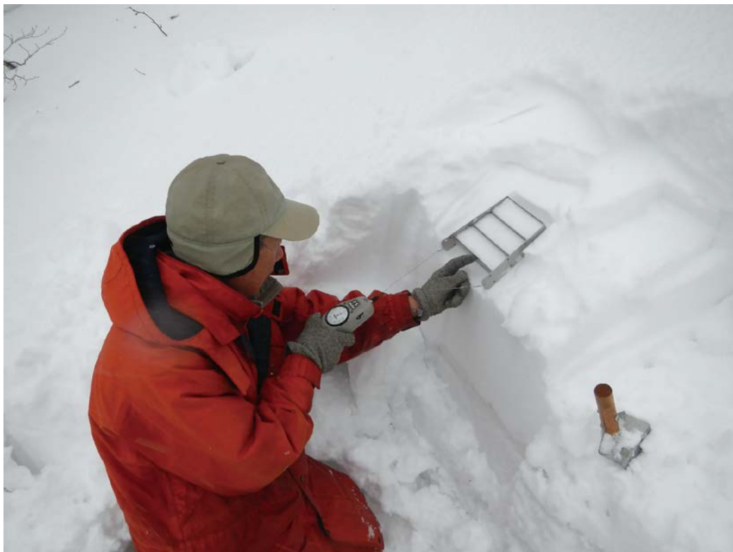
口絵 10 雪崩発生斜面付近での積雪安定度調査 (国道 48 号, 2014 年 2 月 15 日撮影) Fig. 10 Snow stability test nearby avalanche slope. (National Route 48 : February 15, 2014)
