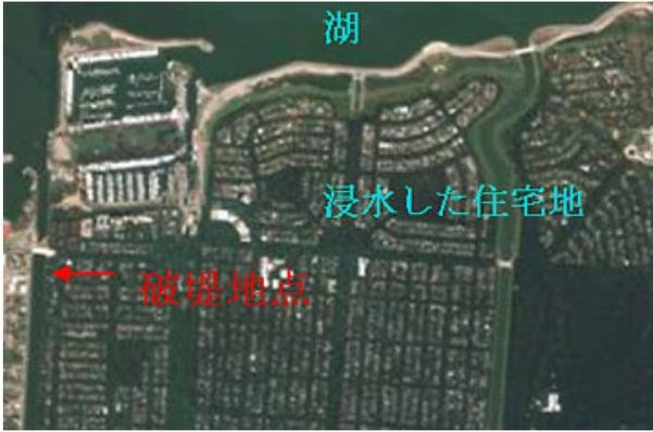
写真1 17th Street Canalの破堤地点付近の浸水 (NOAA, 2005)
