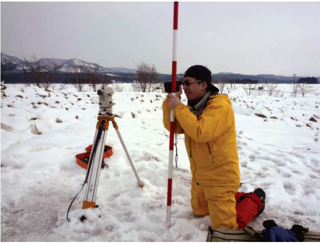
図 4 レーザー距離計による雪山基点から各点までの距離測定(左はセオドライト) Fig. 4 Measurement of length from the base point to each point using a laser rangefinder.
