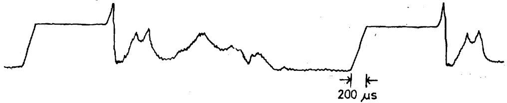
図-3 レーダー・エコー信号に台形の波形をのせたもの
