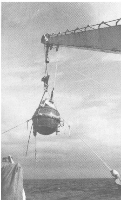
写真4 揚収のために海面から吊り上げられた海底地震計。
