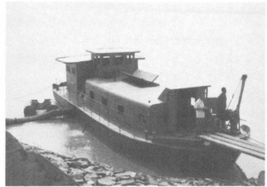
写真3 大店險工の浚渫船：堤防拡幅用の土砂を吸い上げている。
