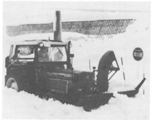
写真1 新規開発ロータリ除雪車の除雪試験
