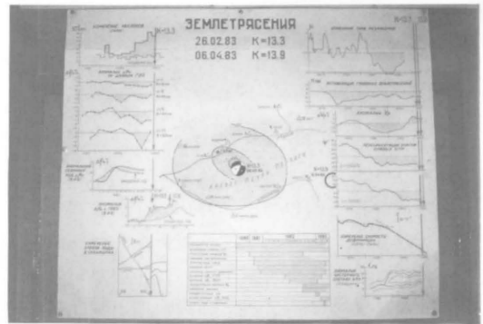
写真2 1983年2月26日の地震の各種前兆現象を示すパネル：左側上から、傾斜・比抵抗・地下水位、右側上から、メカニズム解・地震活動の深度・P波速度・歪・スペクトル変化。
