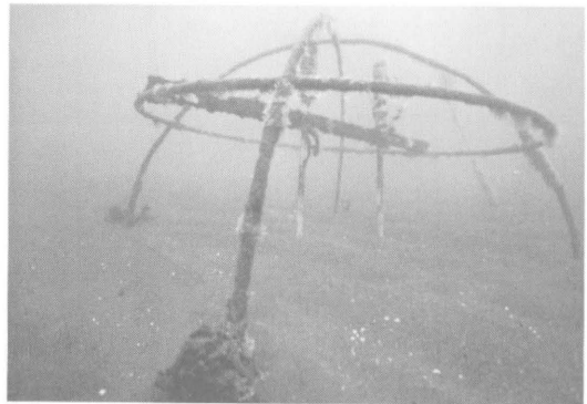
写真1 相模川河口沖500mに設置された砂面計（2台、南北方向50cmの間隔、第2回目の観測）
