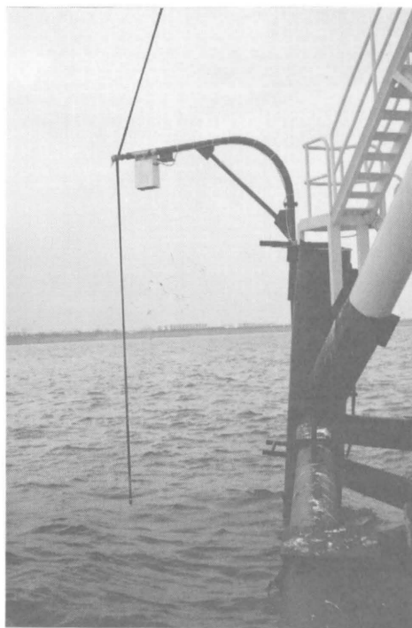
写真 2.2 観測塔に設置された容量型波高計のセンサー
