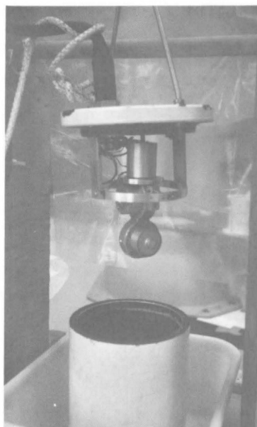
写真8 マサチューセッツ工科大学で開発された海底地震計のセンサー部（ジンバルにより吊り下げられている3成分型感振器は、高粘性シリコンオイルで満たされた円筒型耐圧容器に収納される）
