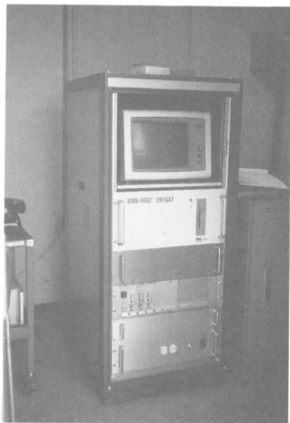
写真1 固定点連続観測用の干渉観測型GPS受信装置
