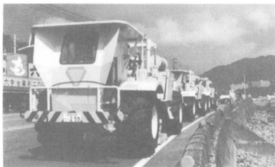
写真1 観測状況 (パイプレーターと地震計)
