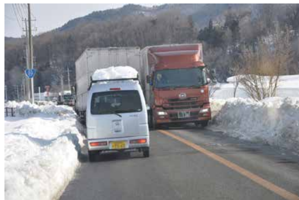
図21 国道20号線で雪による幅員減少のためすれ違うのに苦労する大型トラック Fig. 21 The large trucks hard to pass each other on National Route 20 with the road width narrowing because of removed snow.
