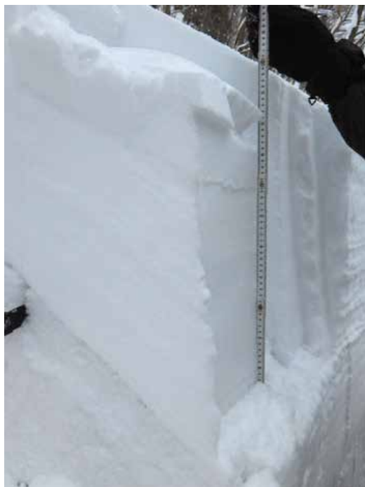
図8 関山峠のコンプレッションテスト後の積雪断面 (2015年2月1日) Fig. 8 Snow column observed after the compression test in Sekiyama Pass (February 1, 2015).
