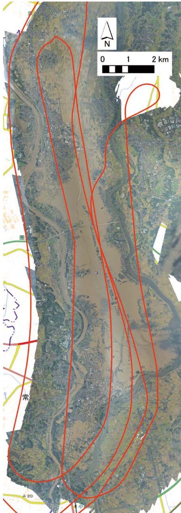
図 2 対象地域における実際の飛行コース(赤線) 写真地図は9月11日に撮影した写真から作成したオルソモザイク画像。背景は地理院地図(国土地理院) Fig. 2 Actual flight course in the target area (red line). This photo map is an orthomosaic image created from the pictures taken on September 11. The background map is the GSI-Maps (Geospatial Information Authority of Japan).
