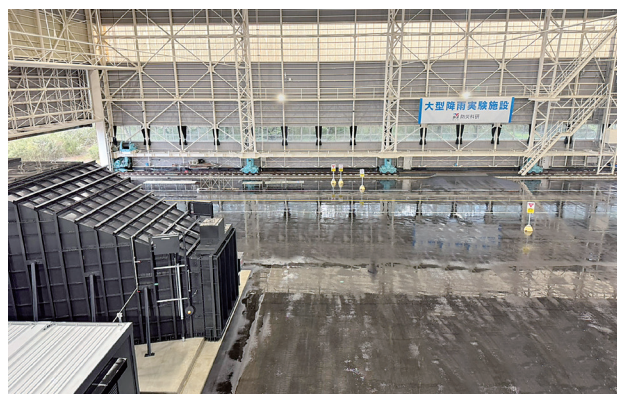
図1 上：大型降雨実験施設内での豪雨(300mm/h)、中：強風装置で用いる大型ファン、下：強風装置の全景、風口は3m×3m、天井には降雨システムがあり、暴風雨の再現が可能
