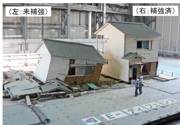
図5 木造住宅の補強効果の検証実験（2005年）
