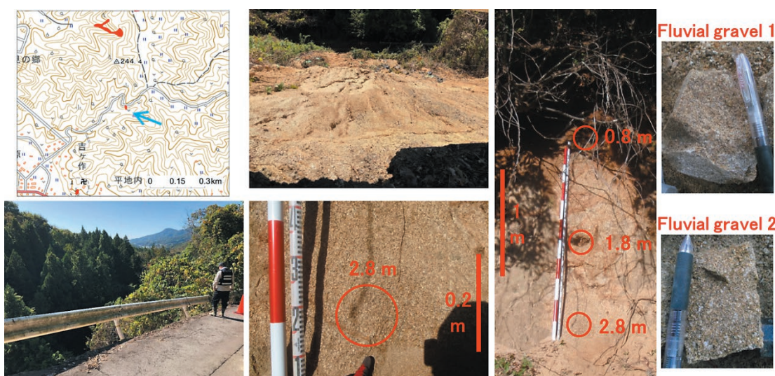
図 4 地点 4 (G 2 a, 花崗閃緑岩) の斜面崩壊の様子. (左上) 斜面位置. 赤色は土砂移動範囲であり, 矢印で示す崩壊を調査した. 背景は国土地理院の標準地図 (等高線間隔 10 m). (左下) 崩壊地の上部. ガードレールを残して薄く崩れていた. (中央上) 崩壊地上側から見た崩壊地の様子. 崩土が下方の林道まで流入した. (中央右) 崩壊地の上部にある切り取り露頭の様子. (中央下) この露頭の深度 2.8 m の様子. 試料は赤丸で採取した. 採取した土層はいずれも原位置風化土である. (右) 基盤岩と思われる河床礫試料.
