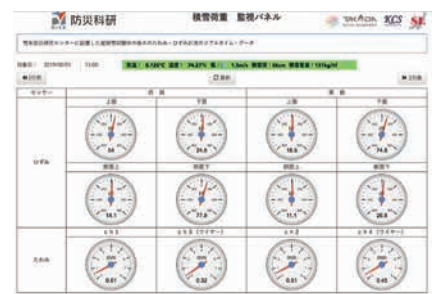
図3 屋根雪試験棟と試験等に設置したIoTセンサーから取得したデータのブラウザ表示ページ
