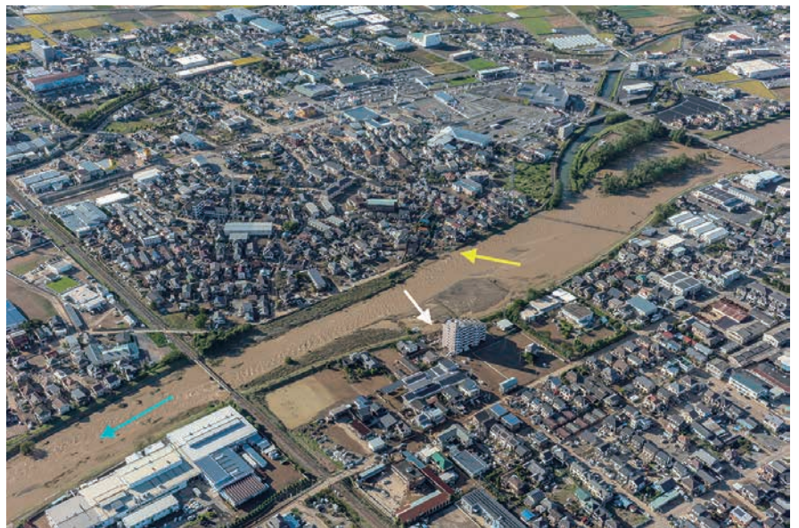
写真1 中流域の被害の例。南流する秋山川（水色矢印）が住宅密集地沿いで破堤（黄色矢印）し、写真の左上端まで浸水。また、その対岸では越流（白矢印）が生じ、広い範囲で住宅地が浸水した。
