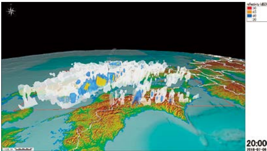
図1 気象庁Cバンドレーダーおよび国土交通省XバンドMPレーダーのデータを合成したレーダー反射因子（雨の強さ）の三次元分布。広島県南上空から見た様子。白・黄・赤色の等値面はそれぞれ30dBZ、40dBZ、45dBZ、50dBZのレーダー反射因子で、降雨強度3mm/時、12mm/時、24mm/時、49mm/時に対応する。図中の矢印（竿）は雲の高さを示すスケールである。地図情報は国土地理院地図（色別標高図）を利用。国土交通省XバンドMPレーダーのデータは、国家基幹技術「海洋地球観測探査システム」：データ統合・解析システム（DIAS）の枠組みの下で収集・提供されたもの。また、気象庁レーダーデータは気象業務支援センターより配信されたもの。作図は櫻井南海子主任研究員による。
